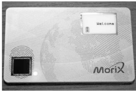
右上に電子ペーパーディスプレイ、左下に指紋センサーを配置したICカード
